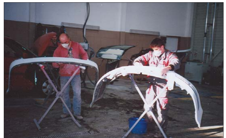
V prípravni na lakovanie áut sa činili J. Kochanik, Š. Varga a P. Džubik. Jednotlivé dielce najprv zbavia nečistoty, potom ich brúsia, tmelia a až potom putujú do lakovne. Foto: autor reportáže
